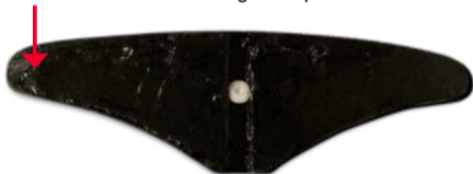
Électrode avec gel manquant
